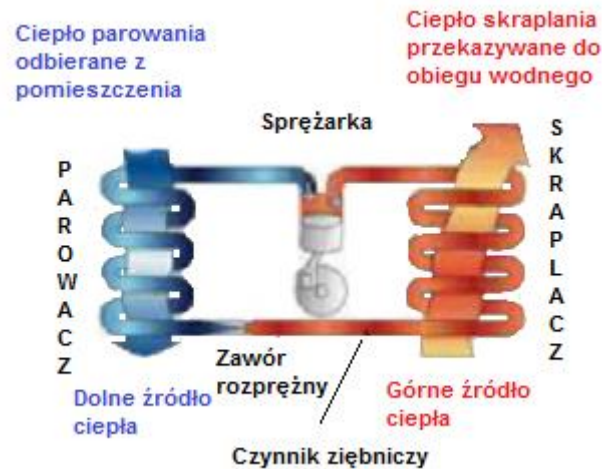
Rysunek 31 Tryb pracy chłodzenia rewersyjnej pompy ciepła
